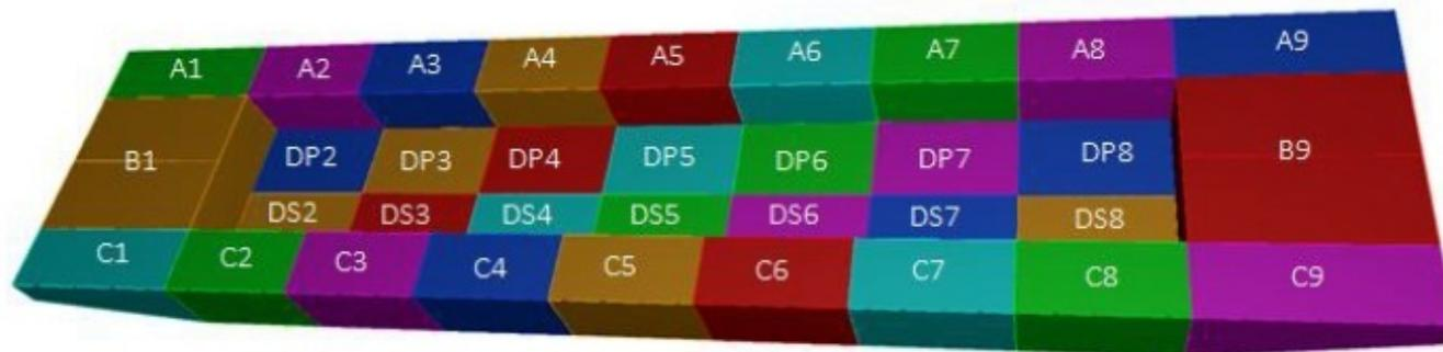
**Piano di capacità delle casse per le acque di zavorra. Ogni pontone è attrezzato con un sistema autonomo di riempimento e svuotamento delle casse.**
